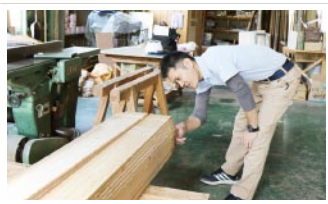
仕入れた資材の確認。枚数だけでなく、割れなど無いか入念なチェックを怠らない
